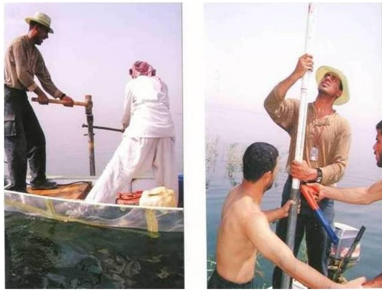
الشكل 3 ب- طريقة جمع النماذج من ترسبات الهور لحفر 2-3 متراً عمقا في الترسبات.
