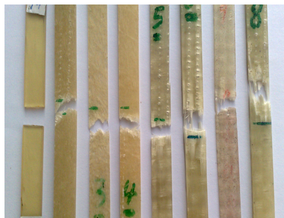
الشكل ١١: العينات بعد انتهاء مرحلة اختبار الشد وفشل هذه العينات وانفصالها إلى جزأين.
